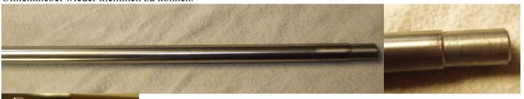
Diesen haben wir im Originalzustand belassen, aber mit einer Kunststoffabstandsscheibe etwas vom hinteren Ende des Lagerblocks abgesetzt. Damit haben wir die hintere Stangenfixierung (gegen vorrutschen) erreicht
