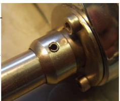
Für die Vordere mußten wir eine Paßhülse drehen, Stange und Hülse zusammen bohren und mittels eines Steckstifts beide Teile verbinden. Diese Hülse liegt locker am Lager auf und verhindert somit den Weg nach hinten. Die 3-Lochscheibe\* sichert das Lager zusätzlich
