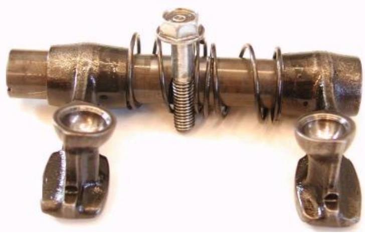
Wenn die Kiphebelflächen keine nennenswerten Beschädigungen aufweisen, sollten sie sofort wieder eingebaut werden, da auf diese Weise eine Verwechslung und damit ein Falscheinbau sofort ausgeschlossen wird. Kleinere Riefen können problemlos mit dem Ölstein abgeschliffen werden.
