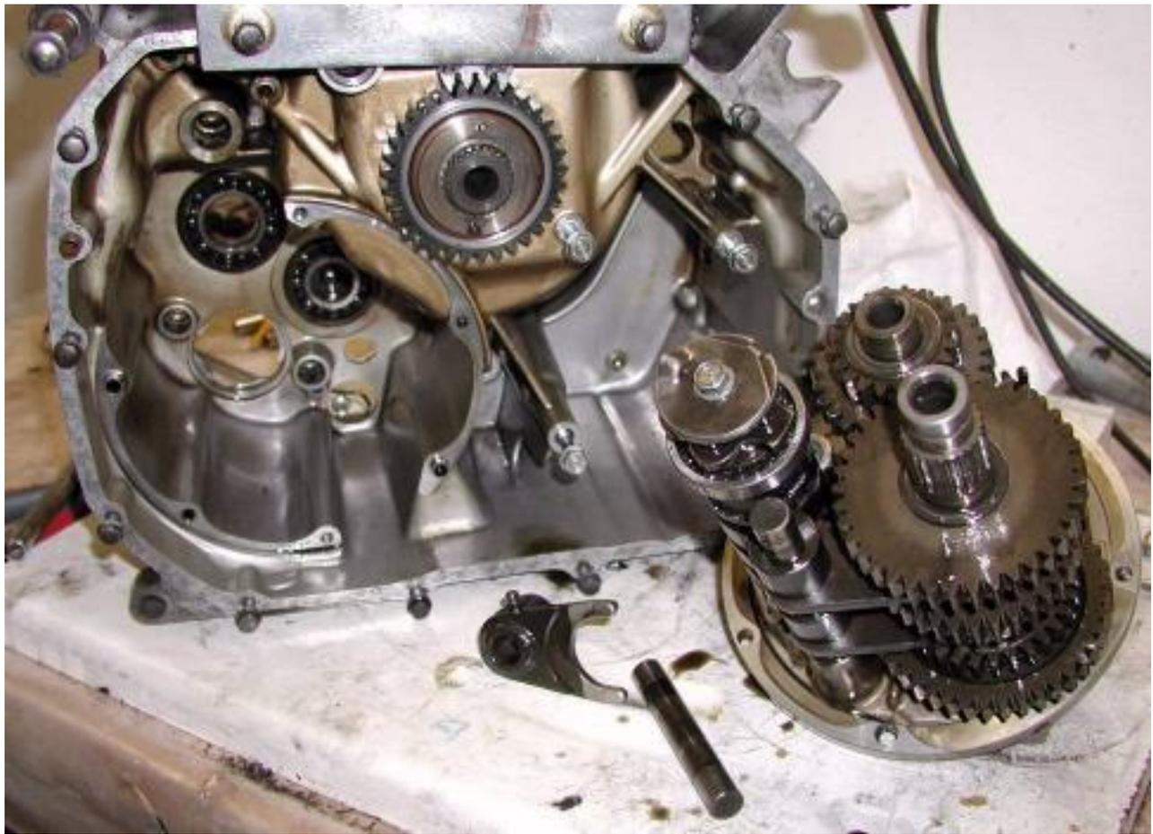
Wie man erkennen kann, wurde die Schraube, die das Hilfszahnrad an der Kurbelwelle befestigt, bereits entfernt, so daß nun mit dem Lösen des Kurbelwellendeckel begonnen werden kann. Hierfür wieder der Hinweis auf die Einleitung und en Teil: besondere Werkzeuge. Die im Handbuch beschriebene Methode sollte tunlichst unterlassen werden.
