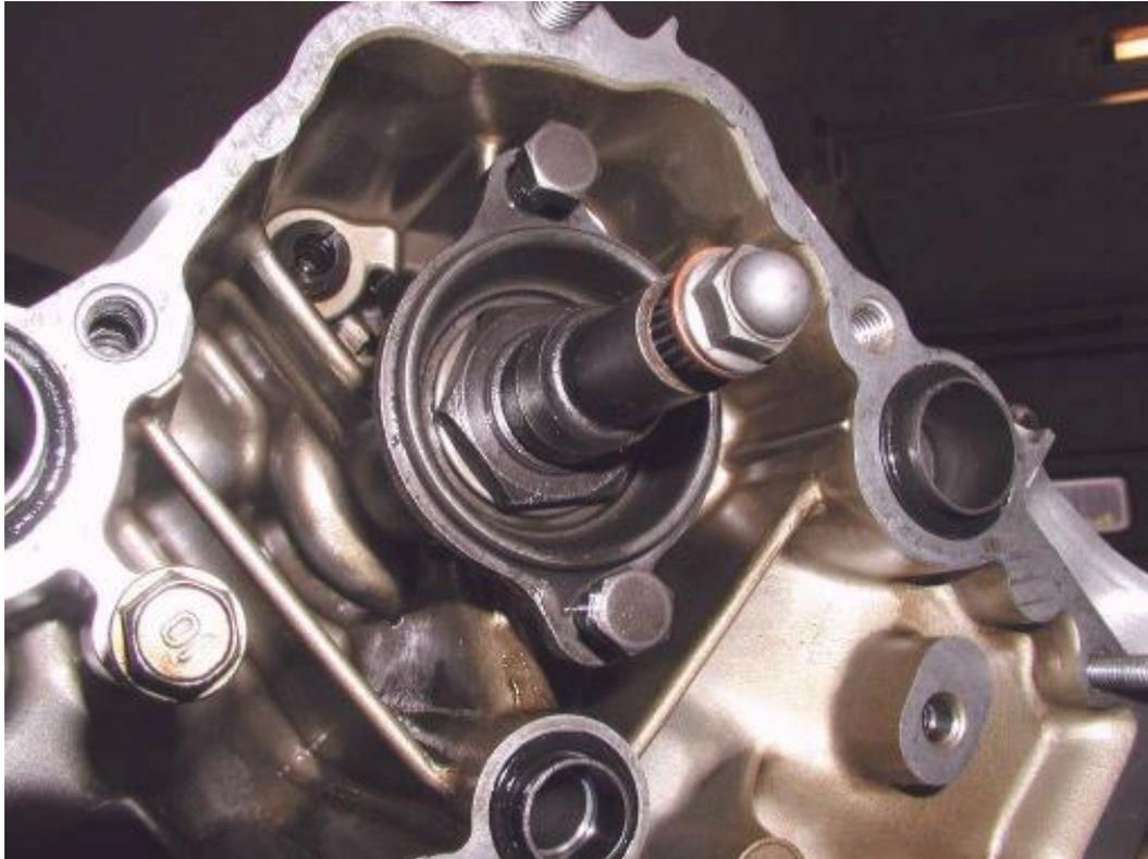
Nachdem das Nockenwellenzahnrad entfernt wurde, kommt wieder ein Spezialwerkzeug zum Einsatz: Die „Nockenwellennuß“
