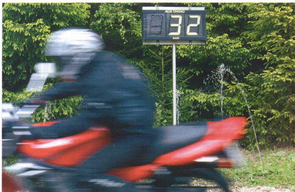
Bis es rutscht. Messung der realisierbaren Kurvengeschwindigkeit im Nassen.
