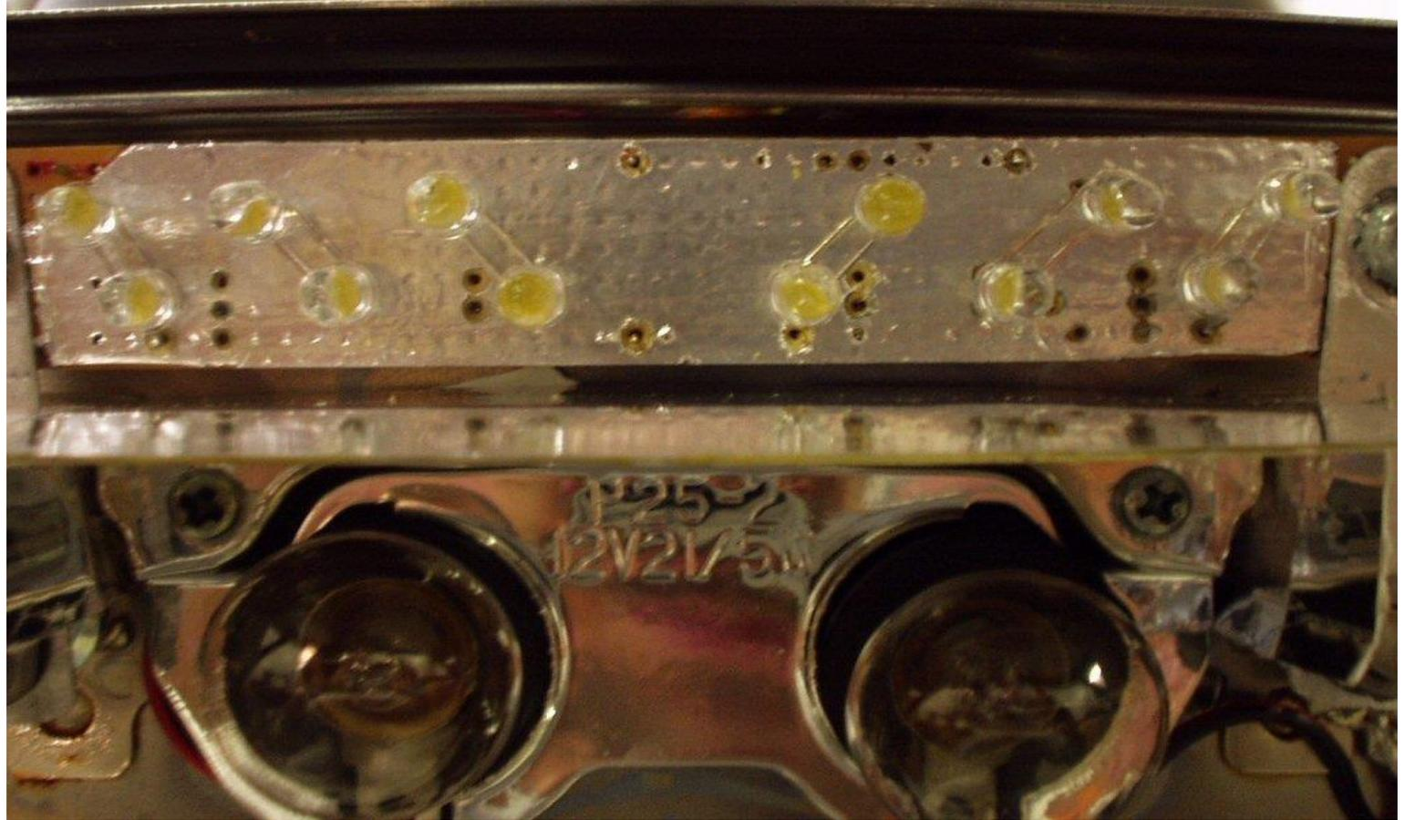
Es bleibt natürlich nicht aus, daß die Technik fortschreitet und auch im Bereich der LED's läuft hier einiges. So kam es dazu, daß mir meine EigenbauLEDkonstruktion durch Korrosion mal die Mitarbeit verweigerte. Ich hab dann eine gekaufte LED-Wechselblinkschaltung UND großflächige OLED's verbaut:
