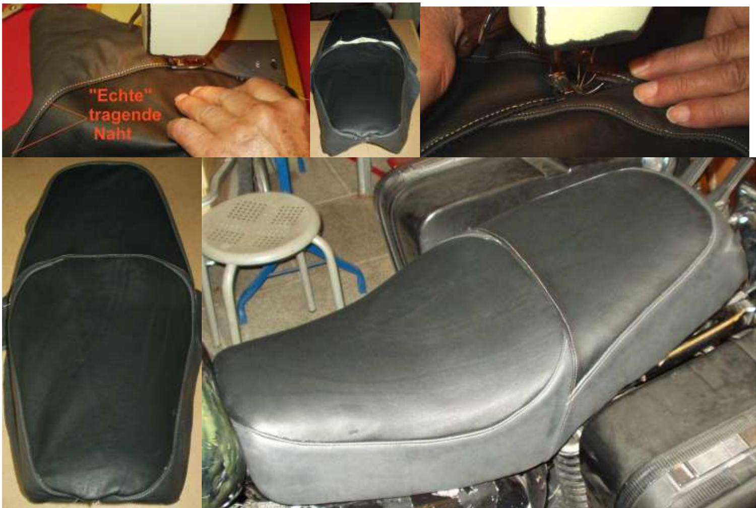
Man sieht hier das fertige Ergebnis bereits aufm Mopped verbaut. An sich recht gut geworden, allerdings ist der Unterbau im Sozusbereich ein wenig nach oben verzogen. Daher schaut es so aus, als würde die gesamte Bank hinten „in die Luft zeigen“. Ist halt der erste Versuch... ggf baue ich noch eine andere.
