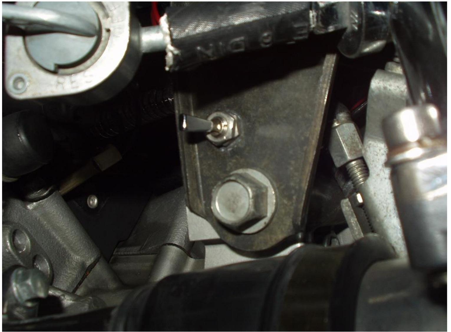
Dieses Teil ist ein sog. 2-poliger Wechselschalter, der 2 getrennte Kontakte besitzt. Der eine ist für die besagte Beleuchtungen (übrigens auch für meinen verbotenerweise beleuchteten Schutzblech-Chrom-Hubbel)
