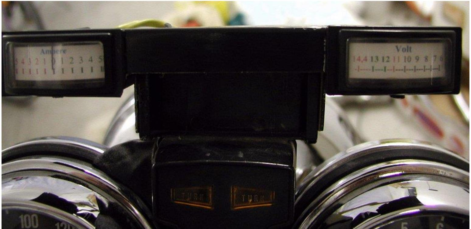
Um einen gegenseitigen Ladungsaustausch durch die unterschiedlichen Batterie-Varianten (verschiedene Innenwiderstände) auszuschließen, habe ich die 2. Bat. mittels eines Lastrelais von der regulären Bordversorgung getrennt, sobald die Zündung auf "AUS" steht. Hat auch den Vorteil, daß bei Spannungsentnahme an den ext. Buchsen (gehen auf die reguläre Batterie) die 2. immer mit gesamter Kapazität für den Startvorgang zur Verfügung steht. Sozusagen eine Art Tankreserve auf der Elektrik-Seite.
