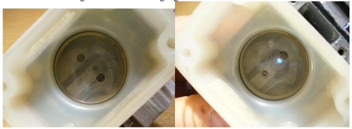
Wie läßt sich dieser Winzling nun durchstoßen, sofern er nach der ganzen Aktion "zu" sein sollte, bzw. wenn die gesamte Mimik noch am Mopped verbaut ist. Hierzu hat sich etwas bewährt, das eigentlich nur sekundär was mit der Bremse zu tun hat..... Beschriftungszettel mit Befestigungsdraht, wie sie bei Inspektionen gern benutzt werden.
