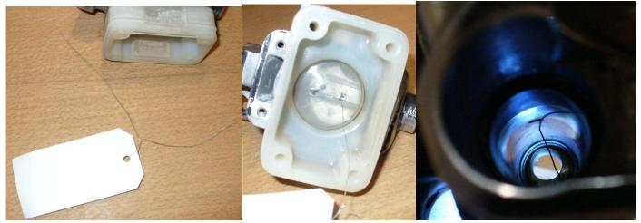
Manchmal sind es die kleinen Dinge, die eine Lösung bringen...so wie in diesem Falle. Sobald sichergestellt ist, daß die Bohrung dauerhaft frei ist, kann mit der Montage des Rep-Satzes begonnen werden. Dieser wird als Einzelteiltüte mit einem kleinen Töpfchen Silikonpaste geliefert.
