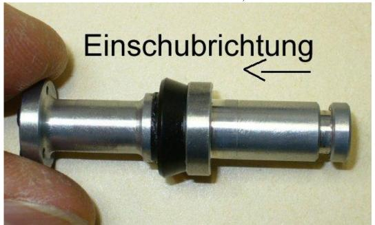
Als nächstes wird auch der Zylinder + Kolben mit Paste eingestrichen (nicht sparsam sein) und der Kolben mit der Feder richtig herum (schmale Federseite zur Maschette) eingeschoben.
