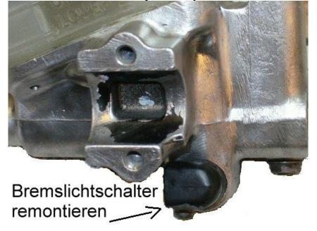
Jetzt kann die "Musik" wieder am Lenker festgeklemmt, die Bremsschlauchhohlschraube montiert und das System mit Bremsflüssigkeit befüllt werden. Zum Thema "Bremsen entlüften" schreibe ich noch eine gesonderte Anleitung
