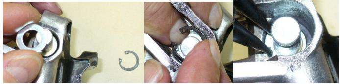
Um sicher zu stellen, daß der Ring auch sauber in der Nut sitzt, sollte mit einem kleinen Schlitzschraubendreher selbiger über die gesamte Ausdehnung nachgedrückt werden. Als letzter Schritt wird die Staubschutzkappe mit Paste bestrichen und vorsichtig mit einem stumpfen Gegenstand montiert.
