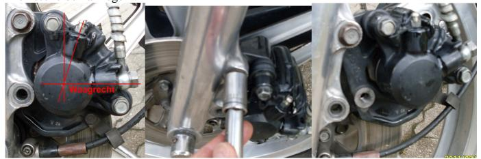
Die einzelne Schraube fixieren und wieder normal entlüften. Dabei wird dann pro Seite ein leichter Blasenschaum austreten. Den Vorgang wiederholen bis nur noch Bremsflüssigkeit kommt, dann den Anker wieder in seine ursprüngliche Lage bringen und alle Schrauben fest ziehen. Spätestens jetzt wird alles im grünen Bereich sein.
