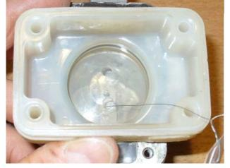
Zunächst wird der Vorratsbehälter geöffnet (Kreuzschlitzschrauben) und bis zur oberen Markierung mit frischer Flüssigkeit aufgefüllt. Hierbei gleich die besagte Ausgleichsöffnung (der Winzling) überprüfen und bei Verdacht vorsichtig mit einem dünnen Draht säubern.
