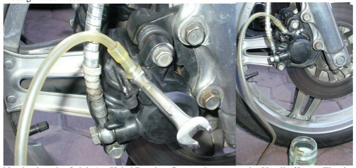
Nun beginnt das Spiel: Am Hebel Druck aufbauen, dann unten das Ventil öffnen > Flüssigkeit und Luftblasen werden entweichen. Hebel oben halten, unten zu machen und oben langsam "nachsaugen" lassen. Dann wieder Druck aufbauen und das Ganze von vorne.... bis im besten Falle der Druck am Hebel beim ersten Mal nach kurzem Weg kommt und vor allem dauerhaft bleibt! Sollte dem nicht so (dauerhafter Druckpunkt) sein, hat sich noch eine
