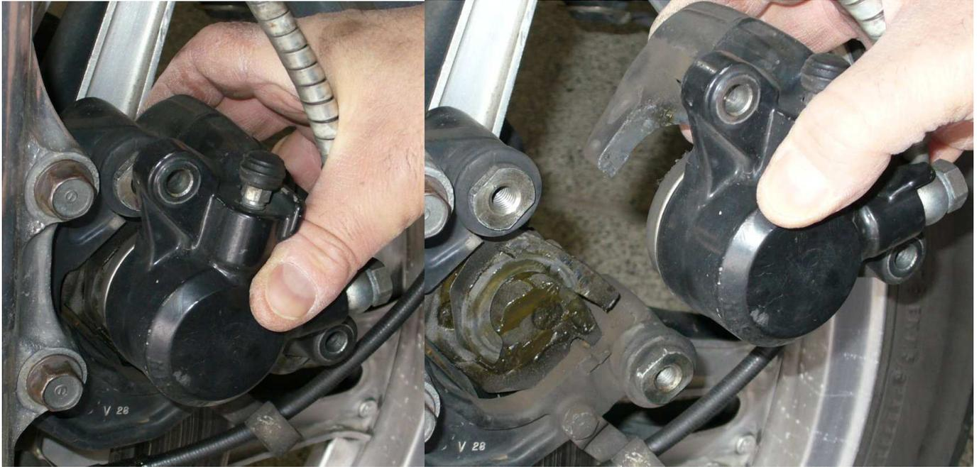
Ein Stück Draht ist nun von Vorteil, um dieses Bauteil mit angeschlossenem Bremsschlauch an einer passenden Stelle zu fixieren. Es ist darauf zu achten, dass der Schlauch nicht geknickt oder über Gebühr beansprucht wird
