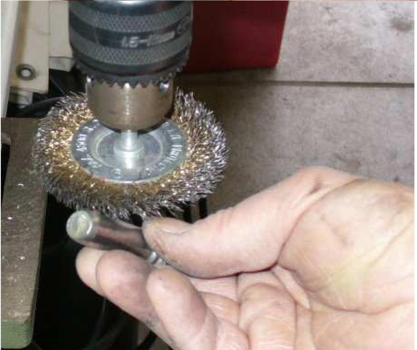
Sobald die Gleitflächen blank sind, werden diese mit Bremsen/Kupferpaste bestrichen (kein Fett !!), um weitere Korrosion zu verlangsamen und auch die Gleitfähigkeit zu erhöhen.
