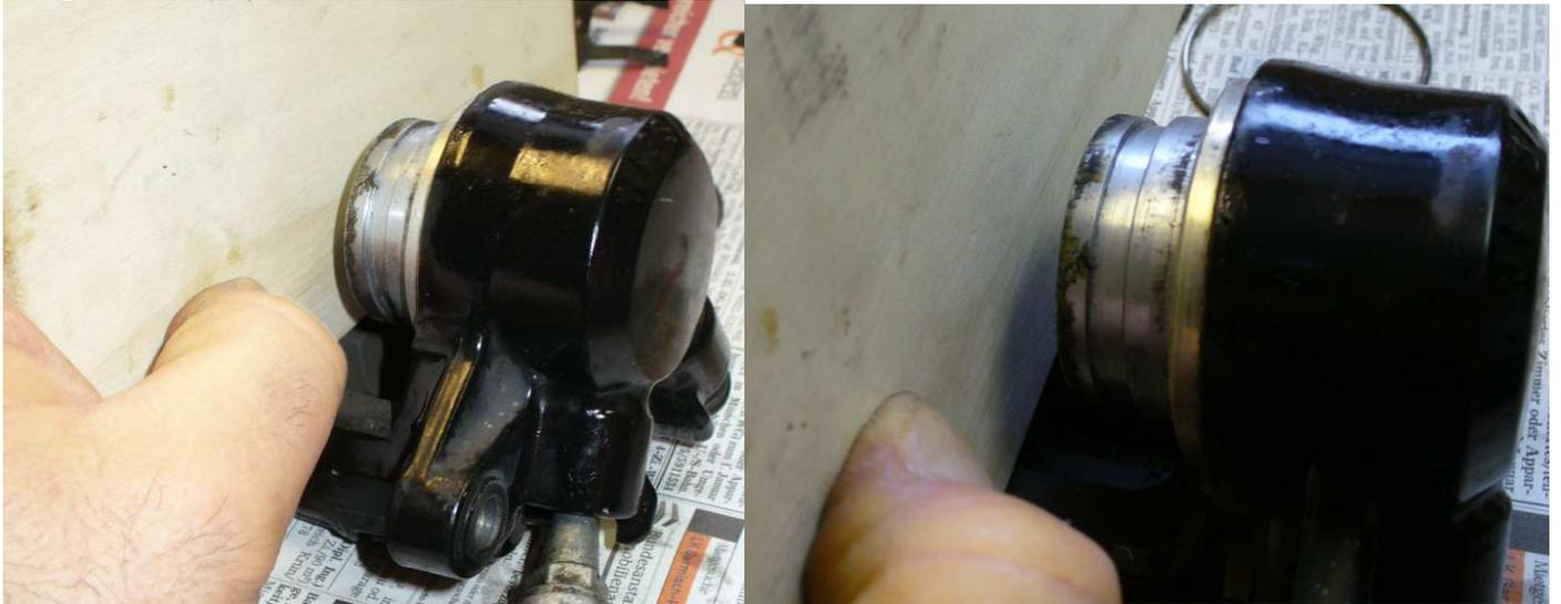
Je nach Kompressor und Fingerfertigkeit an der Druckluftdüse, wird der Kolben mit einem durchaus heftigen „Klank“, gegen das Brett schlagen. Auf diese Weise entfernen wir beide Kolben und erkennen dann das Ausmaß der Verschmutzung an Kolben und Zylinderwand.
