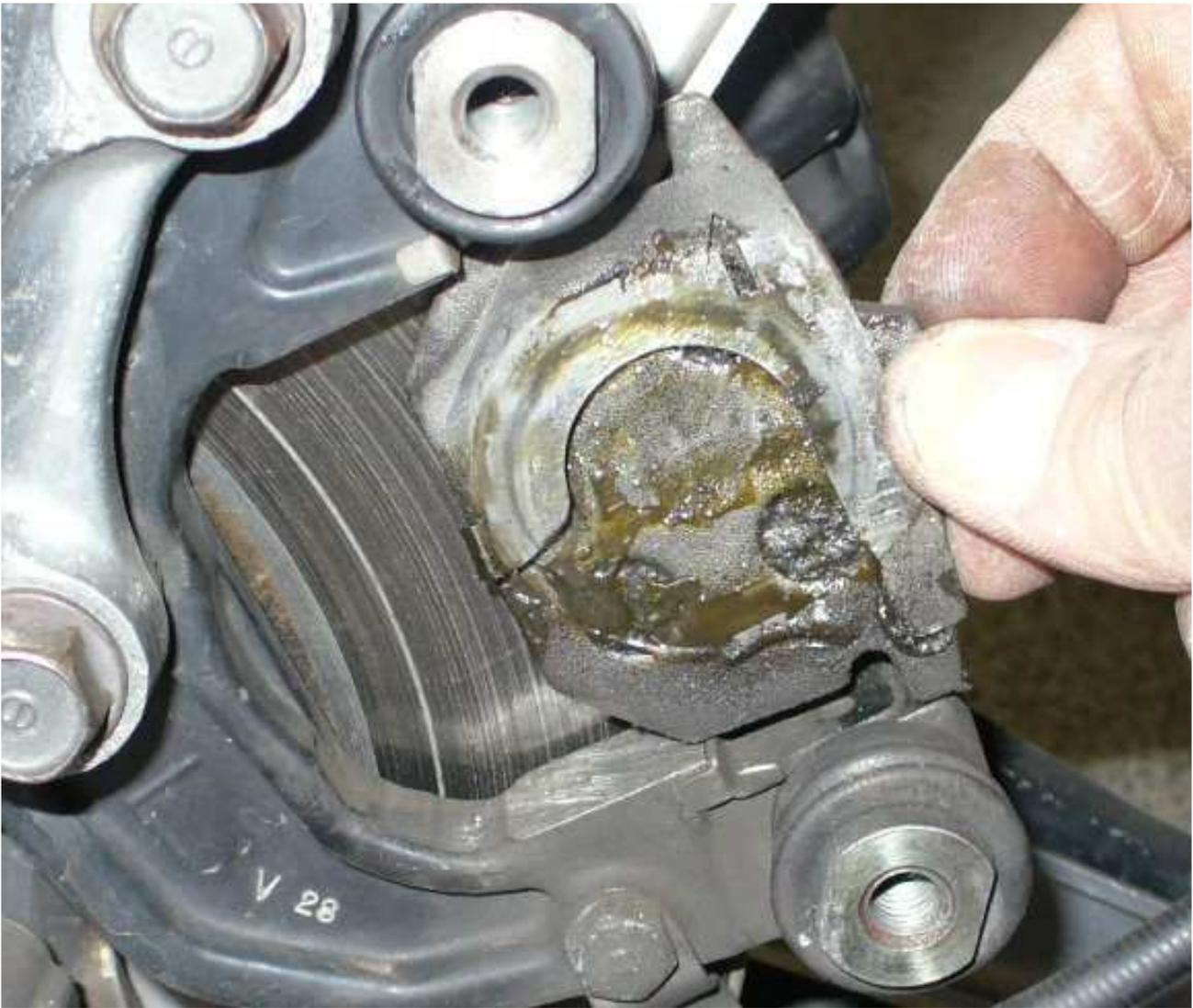
Vor dem Aufsetzen des „Bügels“ sollte das Blech mit einer Schicht Paste bestrichen werden
