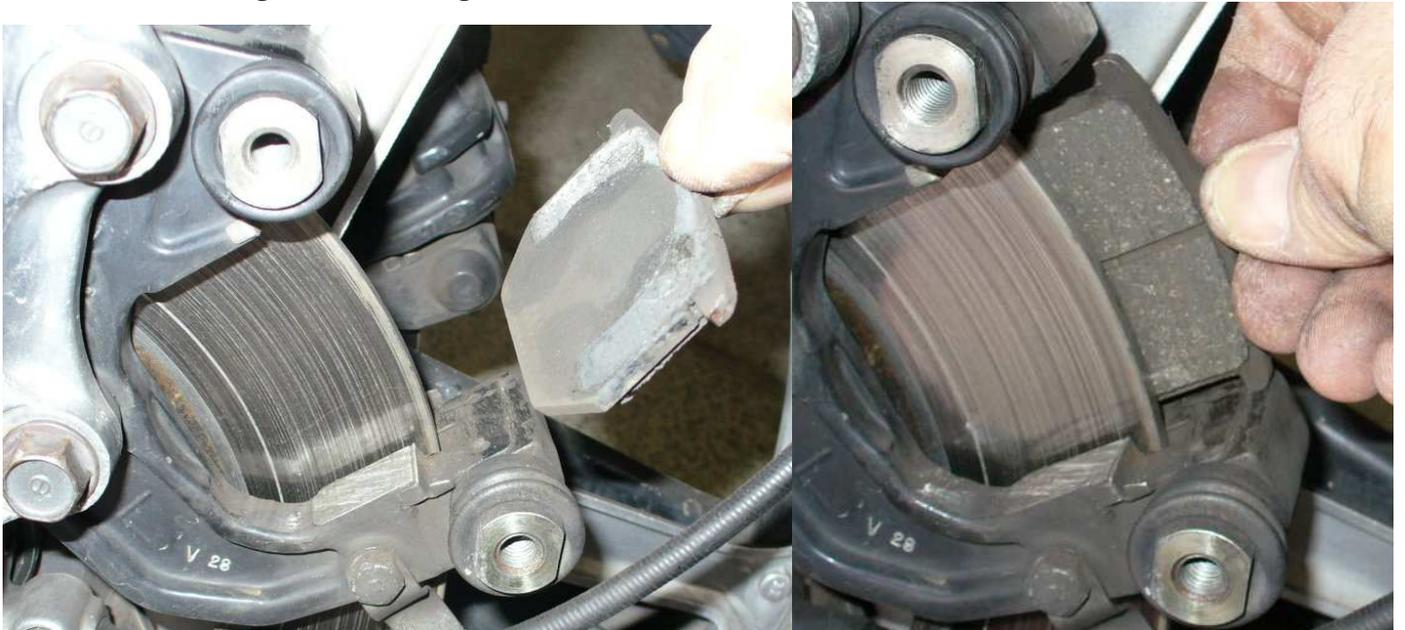
Beim äußeren Belag ist darauf zu achten, dass man das Zwischenblech (zwischen Belag und Bremskolben) nicht vergisst.
