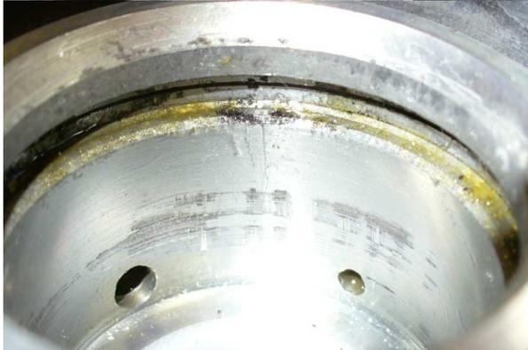
Je nach Art und Stärke der Verschmutzung reicht zur Reinigung die schon Eingangs erwähnte Polierpaste oder man muß bis zu sehr feinem Schleifpapier gehen. Wobei „sehr fein“ im Bereich 600´er bis Polierleinen geht. Keinesfalls darf bei Schleifpapiernutzung mit zu starkem Druck gearbeitet werden. Fertig ist man, sobald keine Unebenheiten mehr spürbar sind. Sichtbare Problemstellen sind nicht relevant, die werden immer zurückbleiben.
