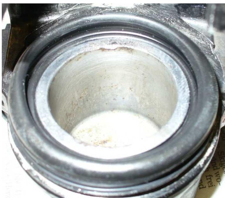
Da auf der Außenseite des Zylinders keine Nut für den Gummi vorhanden ist, muß dieser vollständig, also bis unten auf die Außenseite des Zylindergehäuses gezogen und dann der Klemmring übergestreift werden. Auch beim Ring ist auf korrekten Sitz über den gesamten Umfang zu achten.
