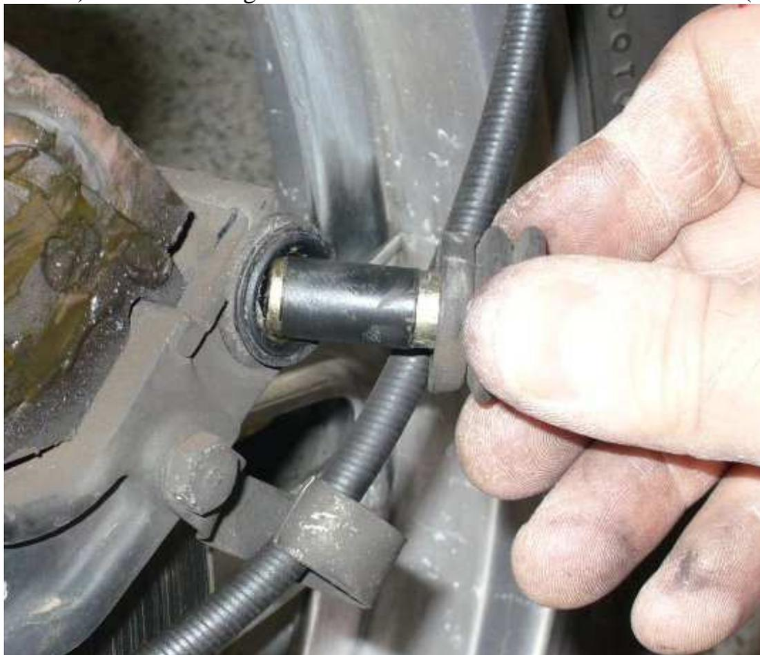
Um die Freigängigkeit der Beläge zu garantieren, sollten die beiden Gleitflächen (hier hauptsächlich die untere) von allen Ablagerungen befreit werden.
