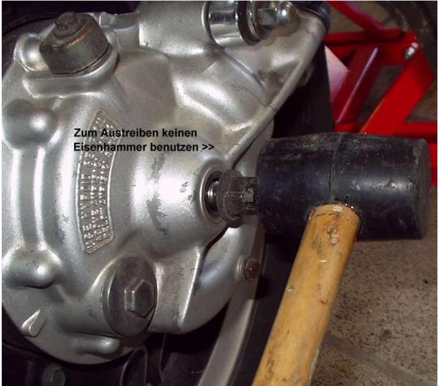
Sollte sich die Achse als extrem störrisch erweisen und der Weg des Gewindes nicht ausreichen um diese aus dem Endantriebsgehäuse zu ziehen, dann muß ein Messingdorn oder Hartholzstift zum Einsatz kommen. Als absoluten „Notnagel“ kann man einen großen Kreuzschlitzschraubendreher nehmen, da die Achse eine Zentrierbohrung besitzt, an der man die Dreherspitze ansetzen kann ohne abzurutschen.
