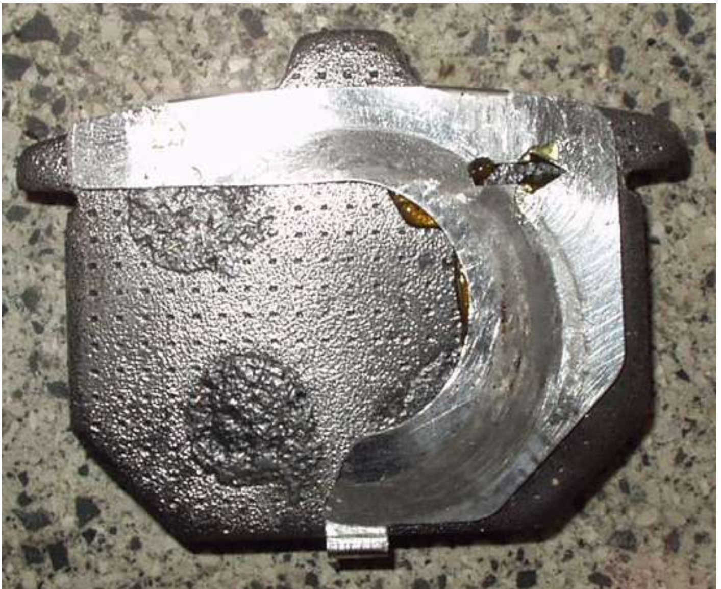
Die Auflageflächen am „Bügel“ sollten nun dünn mit Bremsenpaste versehen und dann die Belagkombination in die „Außenseite“ des „Bügels“ eingelegt werden
