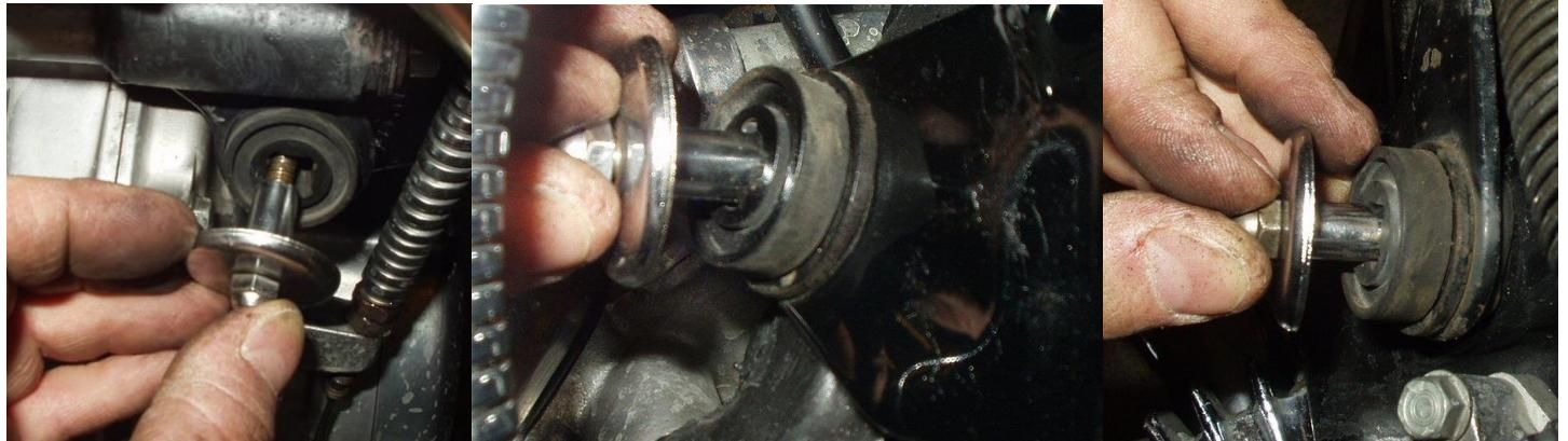
Bevor die Kühlerverkleidung wieder angeschraubt wird, muß noch der Kupplungszug in den Führungshaken am Rahmenrohr geführt werden. Da wir das ja hoch gebogen haben um den Kühlerdeckel vernünftig aufsetzen zu können, müssen diese Deformationen nun wieder rückgängig gemacht werden. Danach kann der Kupplungszug wieder an seinen Platz und die Verkleidung verbaut werden
