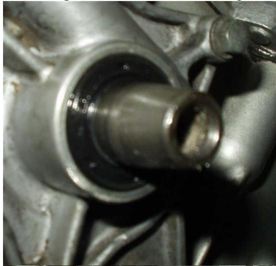
Wie schon geschrieben, könnte man jetzt alles wieder zusammensetzen und sich über die gelungene Reparatur freuen. Allerdings gibt es noch eine Kleinigkeit zu erledigen: Man sollte die weiche Kreuzschlitz-schraube, welche die DZM-Welle im Antriebsgehäuse fixiert, gegen eine VA-Inbusschraube austauschen.
