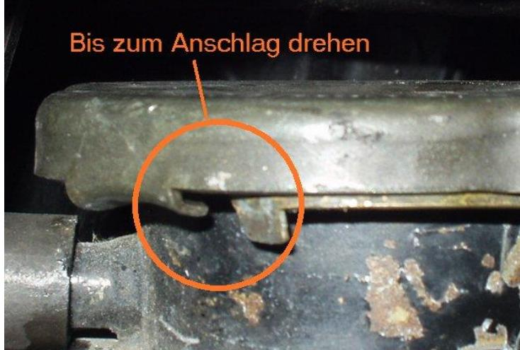
Jetzt ist der Zeitpunkt für den endgültigen Verschluß des Kühlers gekommen, den Deckel aufsetzen, vollständig schließen und anschließend die 3 Befestigungsschrauben wieder einsetzen.
