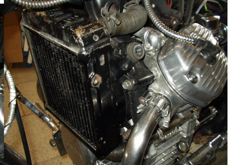
Spätestens JETZT sollte man die Kühlerablaßschraube wieder einsetzen.... Sonst vergißt man das und die Suppe läuft beim kommenden Befüllen munter wieder raus. Dann den Überlaufschlauch aufstecken und den Sicherungsring repositionieren
