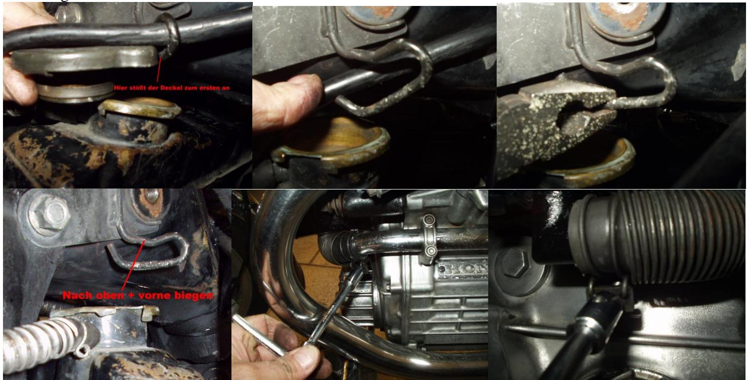
Nun sollten die Schlauchschellen in Position gebracht und festgezogen werden, damit das System mit der 50:50 Mischung Wasser + Glysantin befüllt werden kann.
