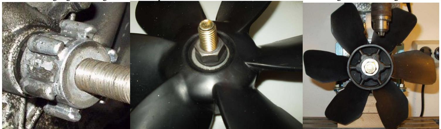
Man kann versuchen, die Bohrungen auch nur mit der Ständerbohrmaschine oder ganz „Freihand“ zu machen, aber ich glaube nicht, daß dies g'scheite Ergebnisse bringt. Vor allem sollten die Bohrungen und Schrauben wegen der möglichen Unwucht alle ziemlich gleich verteilt sitzen. Den langen Bohrer hab ich vom OBI 3 x 100mm
