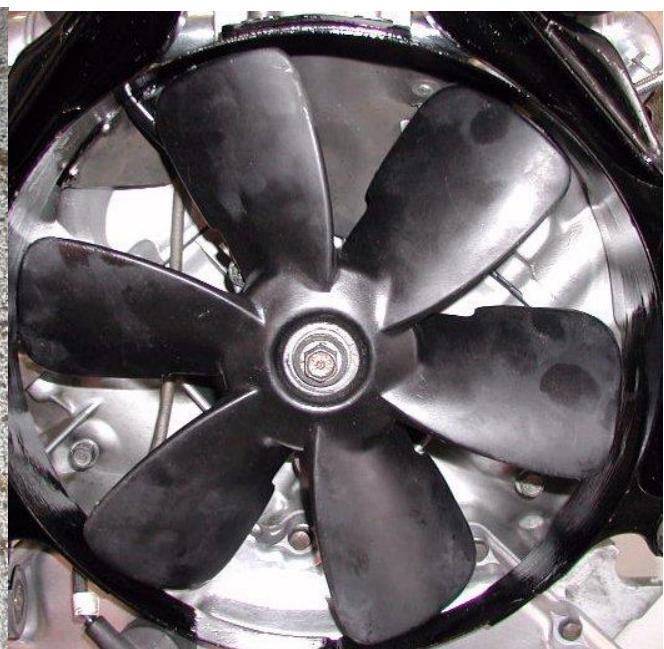
Erst dann wird das Lüfterrad aufgesetzt und die Schraube eingedreht. Diese muß mit 20 – 25 Nm angezogen werden. Über die Blockiermethoden habe ich schon gesprochen.
