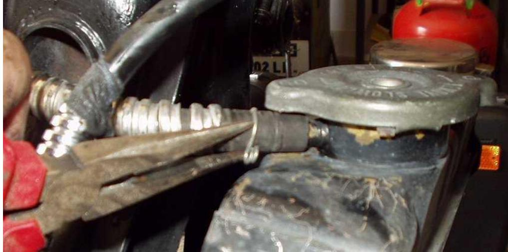
Im Bild oben sieht man, dass ich alle Schlauchschellen lockere, das hat den Vorteil, dass die Scherkräfte auf die Schläuche (durch Verkleben) beim Entfernen des Kühlers nicht so groß werden >> doppelte „Angriffsfläche“ und Bewegungsmöglichkeit. Dadurch weniger Beschädigungen. Den Überlaufschlauch am Kühlerdeckel nicht vergessen !!!!
