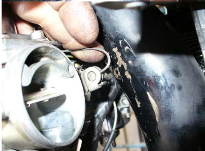
Hier deutlich zu sehen, wie lang das Innenkabel in Richtung Rahmen steht. Durch diese Maßnahme hat man den Vorteil, genügend Kabellänge für eine ordentliche Schlaufe zu haben und man kann die Chokeklappe zum Einfädeln unbetätigt lassen. Wenn man dies nicht macht, bräuchte man im Allgemeinen 3 Hände um alle Vorgänge gleichzeitig machen zu können
