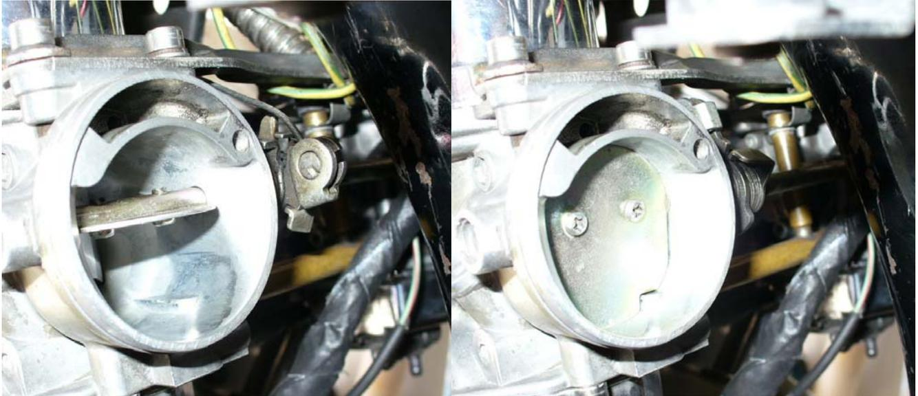
Bei der Klemmung ist zu Beachten, dass diese zum Ersten immer im Metallende der Außenhülle statt findet und nicht am Kunststoffüberzug und zum Zweiten, dass auch nach Befestigung des Lenker-Endes die Klappenfunktion erhalten geblieben ist.
