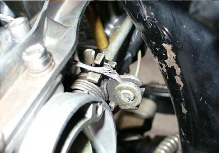
Jetzt die Klemmung der Außenhülle lockern und nach vorne schieben. Danach die Klemmung wieder anziehen
