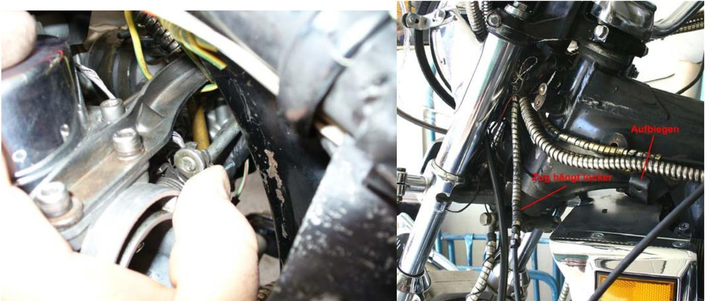
Jetzt muß der Choke-Knopf demontiert werden. Hierbei ist es hilfreich ebenfalls die Haltetasche, die an der Lenkerhalterung geklemmt ist mit zu entfernen. Da ich sehr viel auf Inbus-Schrauben umgerüstet habe, unterscheidet sich hier meine CX vom Original wieder einmal.
