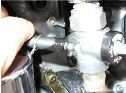
Man kann hier gut sehen, dass die Schläuche mit einem Klemmring gesichert sind, die kann man am besten mit einer kleinen Zange lockern. Beim Abziehen des Schlauchs läuft erfahrungsgemäß immer noch der Rest aus diesem heraus, also am besten einen Lappen über die Ansaugstutzen und Vergaserbatterie legen. Sobald dies geschehen ist, kann der Tank abgenommen werden. Sinnvollerweise wird er gleich auf die schon abgebaute Sitzbank abgelegt.
